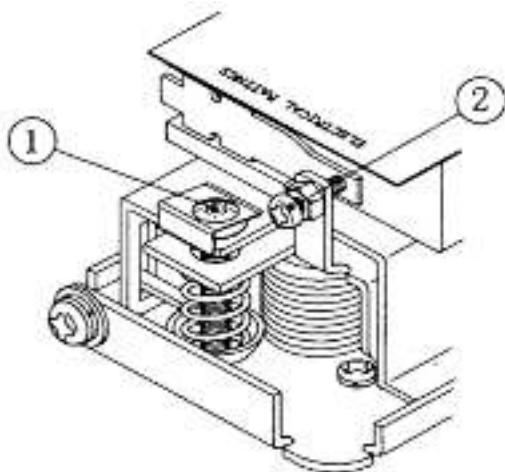
Для настройки требуемой уставки служит регулировочный винт (1). Вращение регулировочного винта по часовой стрелке приводит к срабатыванию при более высоком расходе, против часовой стрелки – к срабатыванию при более низком расходе.
